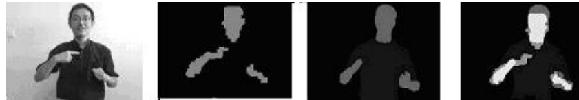
Figure 1. Précision limitée du recalage sur les régions : les images sont respectivement l'image acquise puis segmentée, la projection du modèle 3D et enfin la superposition de la projection du modèle avec l'image segmentée. La pose du modèle 3D diffère de celle de l'acteur observé car le recalage sur les régions n'est pas précis.
