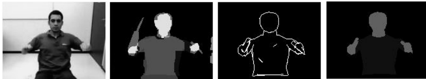
Figure 5. Exemple de la correction d'un recalage sur les régions incorrect. Les images sont respectivement l'image acquise puis la superposition de la projection du modèle avec l'image segmentée qui montre le recalage sur les régions incorrect, les contours occultants du modèle 3D qui montrent la correction du recalage sur les contours et enfin la projection de la pose du modèle 3D corrigée.
