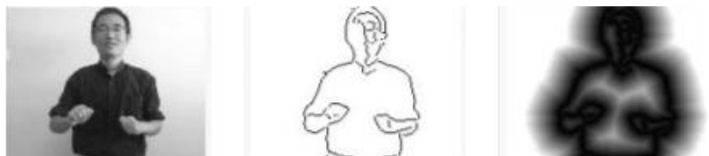
Figure 2. Exemple d'image issue de l'acquisition vidéo, les contours extraits de cette image et la carte de distance aux contours.
