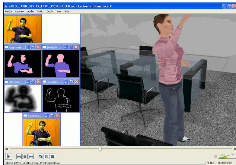
Figure 4: A gauche : en haut, image du flux vidéo ; en dessous, l'image précédente segmentée en classes de couleur, à côté d'une projection du modèle 3D recalculé en maximisant le recouvrement entre régions de colorées ; en troisième ligne, la carte des distances aux contours extraits de l'image vidéo, et la projection des contours occultants du modèle dans la pose ajustée par rapprochement des contours ; en bas : les contours occultants du modèle projetés sur l'image initiale. A droite : la pose 3D restituée en temps réel par l'avatar de l'utilisateur, ici observé latéralement par la caméra virtuelle d'un autre participant. L'environnement virtuel utilise ici la plateforme open source OpenSpace3D (I-Maginer). Des vidéos sont disponibles en ligne à l'adresse : http://MyBlog3D.com (page Demos).
